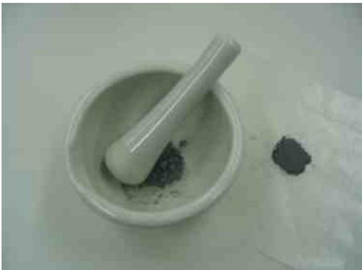
写真 22 乳鉢による粉碎 塗料固形物 1
