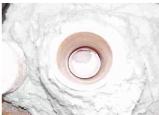
写真 13 加熱中 (体積収縮、色の変化)
