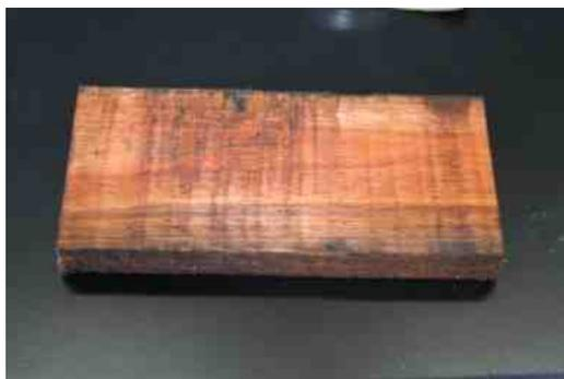
写真 6-2 油のしみ込んだ廃材 B
