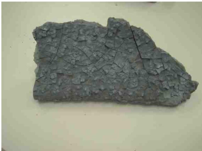
写真 18 鉛を含む塗料固形物 1
