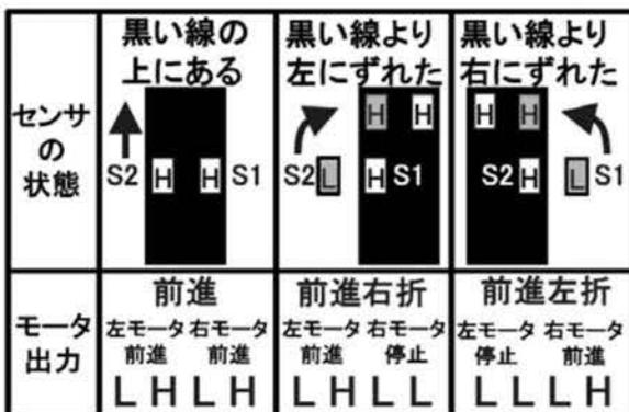
図6 内側センサによる走行制御
