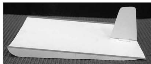
図 3 平板翼機（反りのない主翼）
