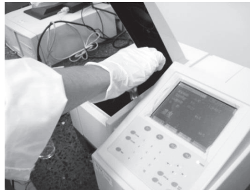
図6 分光光度計による六価クロム測定
