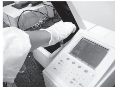
図6 分光光度計による六価クロム測定
