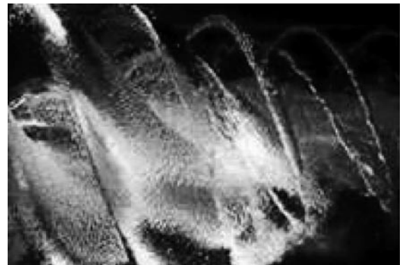
図6 スクリューによる水流
