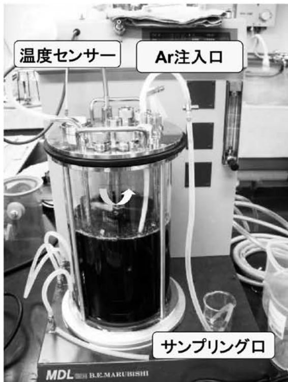
図2 脱窒菌ブロックを用いた脱窒実験 (培養液量3Lで実験 in 5Lジャーファーマンター)
