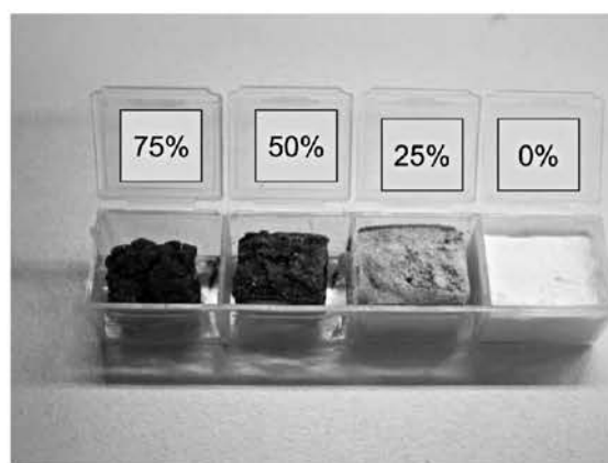
図1 “セメント+廃材(図中の%) +脱窒菌” を混ぜて乾燥させた微生物製剤
