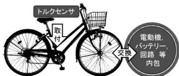
図4 前輪交換方式アタッチメント方式
