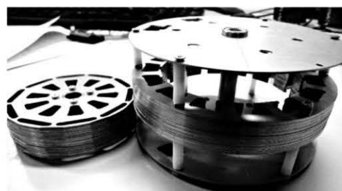
左:ロータ 右:ステータと外層 図8 製作したIPMモータの外観
