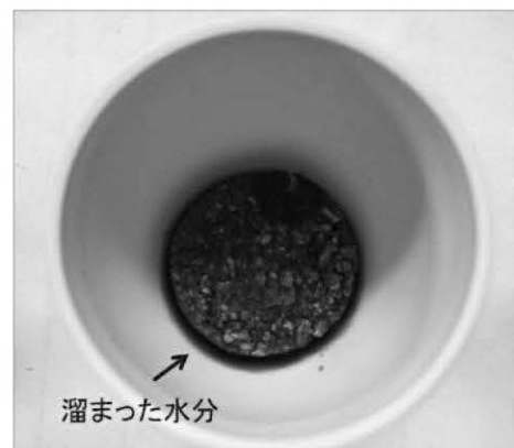
図7 吸水400時間経過後の 錠剤化かんぴょう粉末試料の様子
