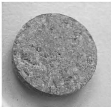
図5 錠剤化したかんぴょう粉末試料 (直径 15mm, 厚さ 2mm)
