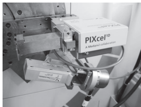
図 2 半導体一次元検出器(上), コリメーターとプロポーショナル検出器(下)
