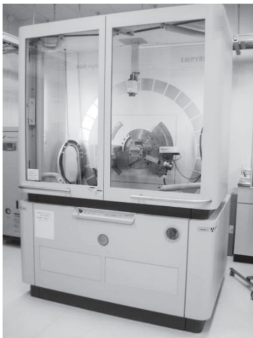
図 1 エックス線回折装置 Empyrean
