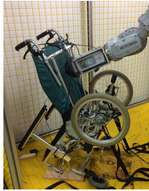
図12 内側方向負荷静的荷重試験
