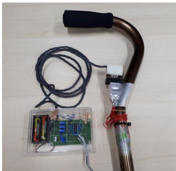
図4 計測用杖とアンプの接続
