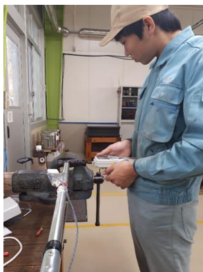
図6 曲げモーメントの校正
