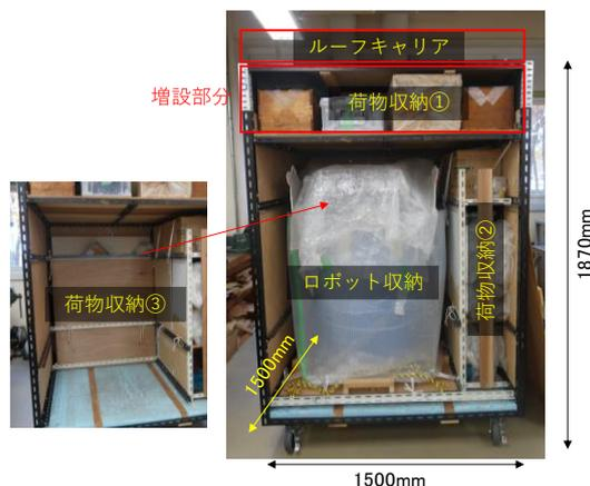
図8 全国大会用のロボット搬出用台車の収納の様子
