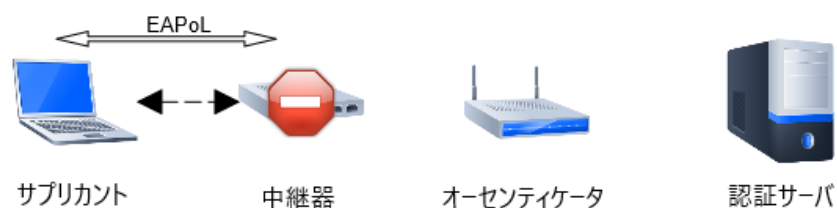
図 6 中継器が EAPoL に対応していない場合
