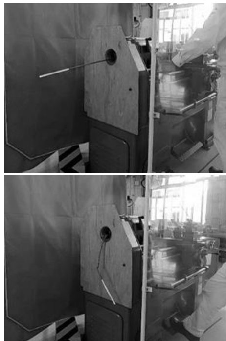
図2 銅パイプが折れ曲がる様子
