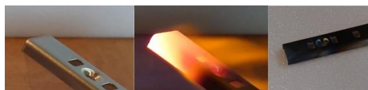
図 2. 高温加熱による酸化被膜の生成
