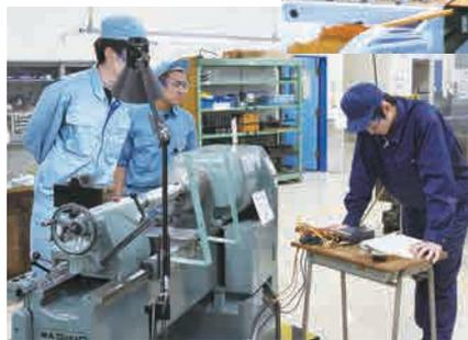
工学実験（切削抵抗の測定）
