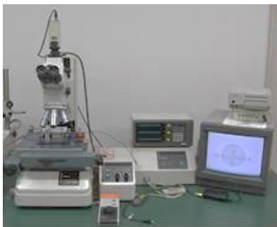
その場観察によるフレットング摩耗試験
