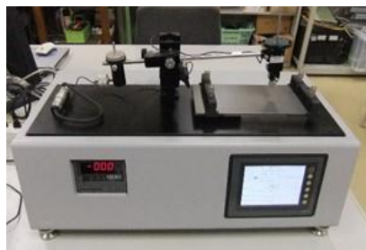
往復摩擦試験機 (新東化学 HEIDON Type38)
