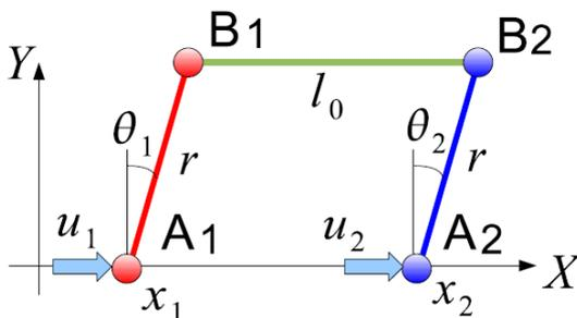
図1 結合倒立振り子モデル
