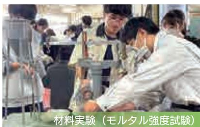
材料実験 (モルタル強度試験)
