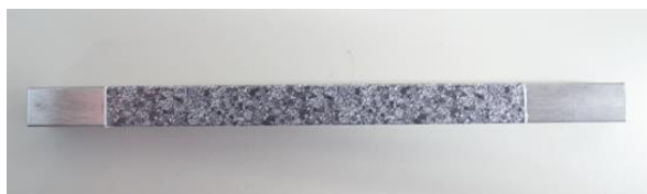
図4 画像相関法による計測を容易にするためのパターンシールを貼付した試験片
