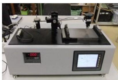
往復摩擦試験機 (新東化学 HEIDON Type38)
